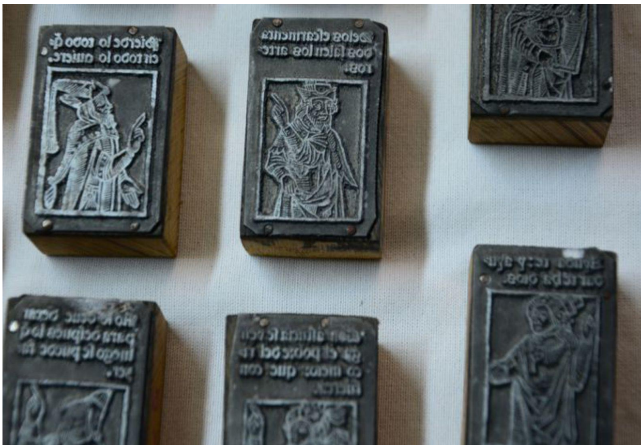
Las planchas de impresión están formadas por un taco de madera y una placa de zinc con el relieve. Gonzalo Núñez
